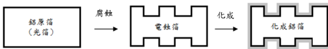
圖 1 鋁電解電容器用陽極化成鋁箔主要製程
